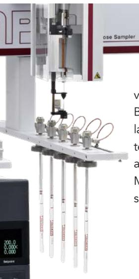
Mit dem GERSTEL-TubeSpiking-System (TSS) lassen sich normgerechte Standards für die Thermodesorption vollautomatisiert erstellen. Bis zu fünf Sorbensröhrchen lassen sich in den TSS-Halterungen befestigen und automatisiert mit Hilfe des MPS mit Standards beschicken.
