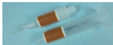
Figura 2: Arriba: Cartuchos SPE configurados para el SPE GERSTEL automatizado. Abajo: Cartuchos estándar SPE.
