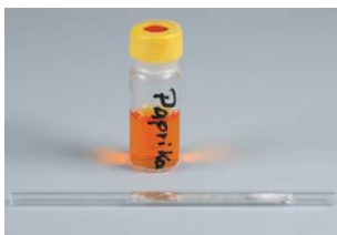
Figura 2: Frasco de 2 mL con el extracto de pimentón producido por el método QuEChERS y un liner relleno con fibra de vidrio al cual fueron inyectados 5 μL del extracto.
